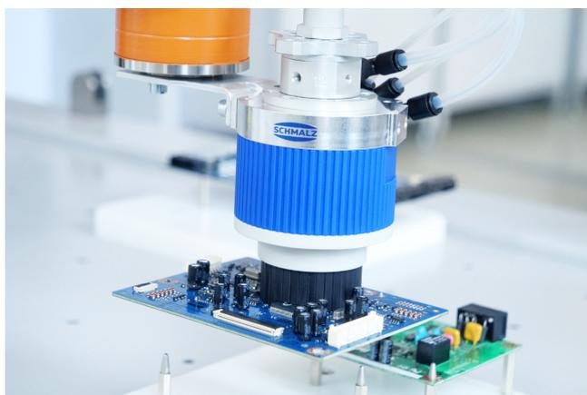
Préhenseur à flux SCG-HSS lors de la manipulation de circuits imprimés équipés
